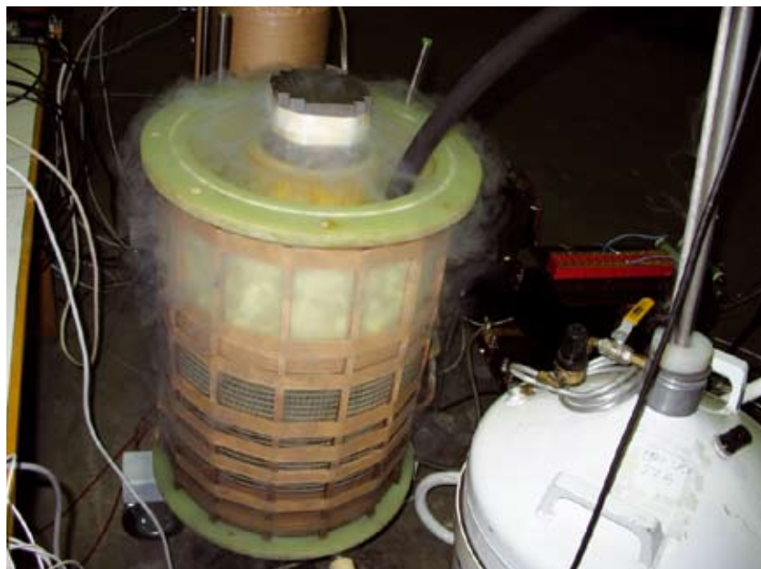
Le cryostat 20 kVA livré à Budapest est en matériau composite (verre époxy). Un second de 100 kVA sera bientôt réalisé.
