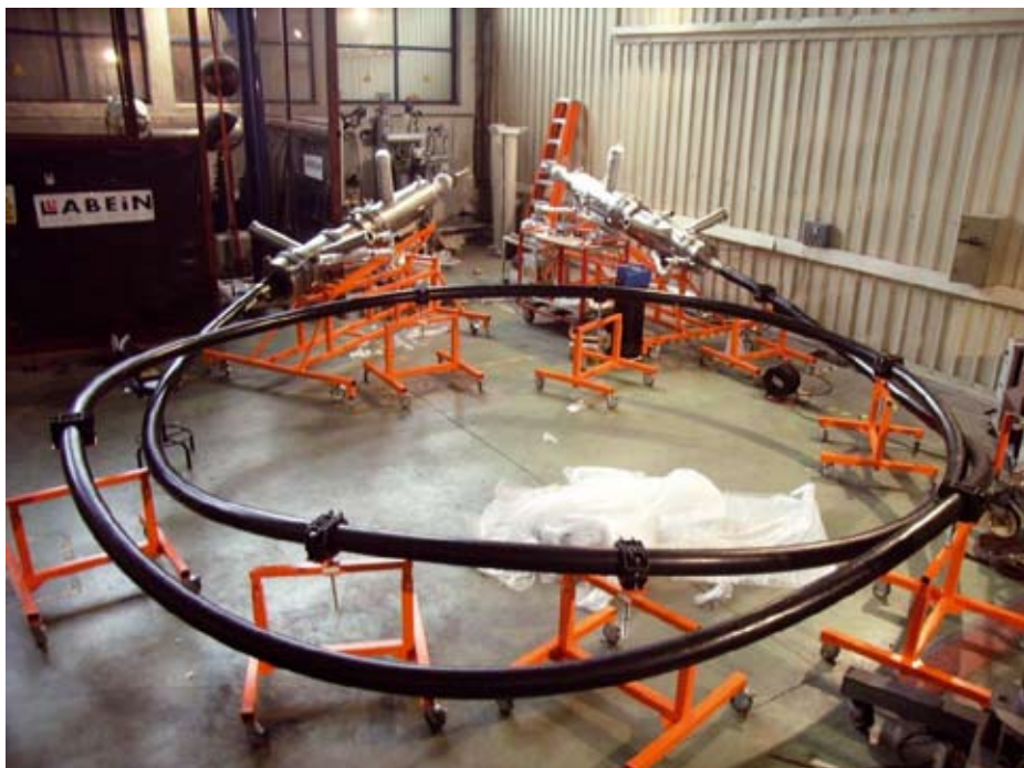
À Bilbao, Air Liquide DTA a livré un réfrigérateur permettant de refroidir le câble Super 3C, ici visible en atelier avec deux cryostats à ses deux extrémités.
