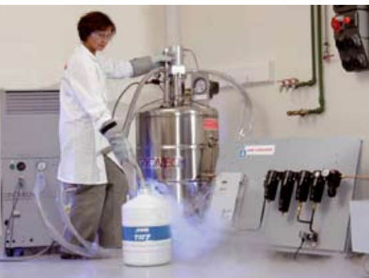
Le LNP comporte notamment un refroidisseur cryogénique de technologie Gifford-MacMahon produit par la société CRYOMECH (Syracuse, New York).
